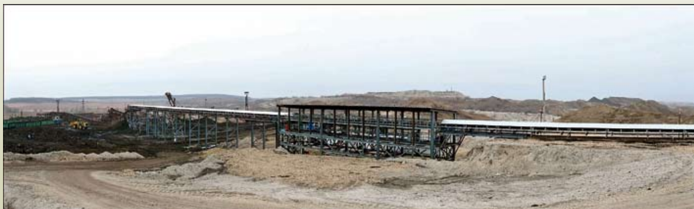
Ленточный конвейер производства H+E Logistik GmbH (Германия) в РУ «Новошахтинское» для доставки добытого угля на пункт погрузки в вагоны
