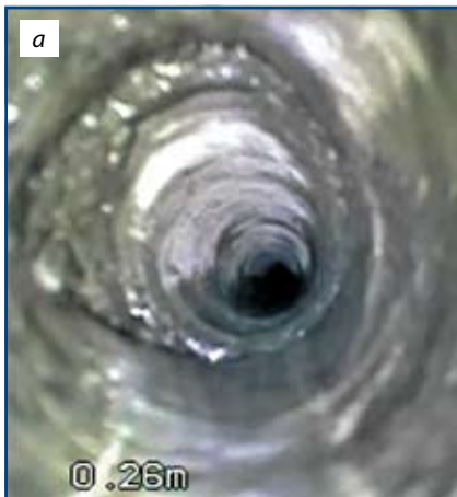
Рис. 6. Скважина № 15 с инициирующей щелью до гидроразрыва: а — устье скважины; б — забой скважины
