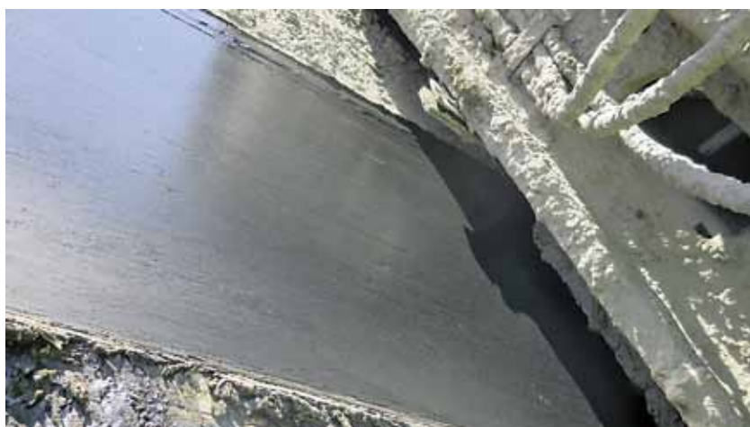
Рис. 2. Фрагмент распределения смазки на рукояти ковша
