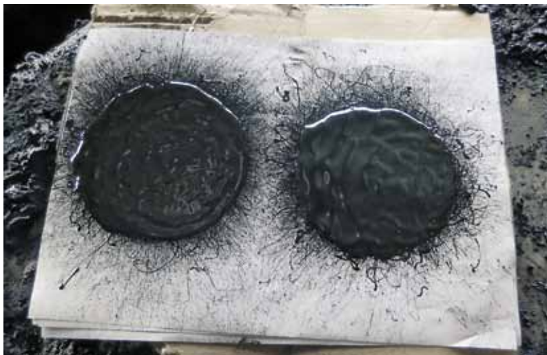
Рис. 4. Проверка распыляемости смазки Shell Gadus S4 OGT 0 на бумажном экране
