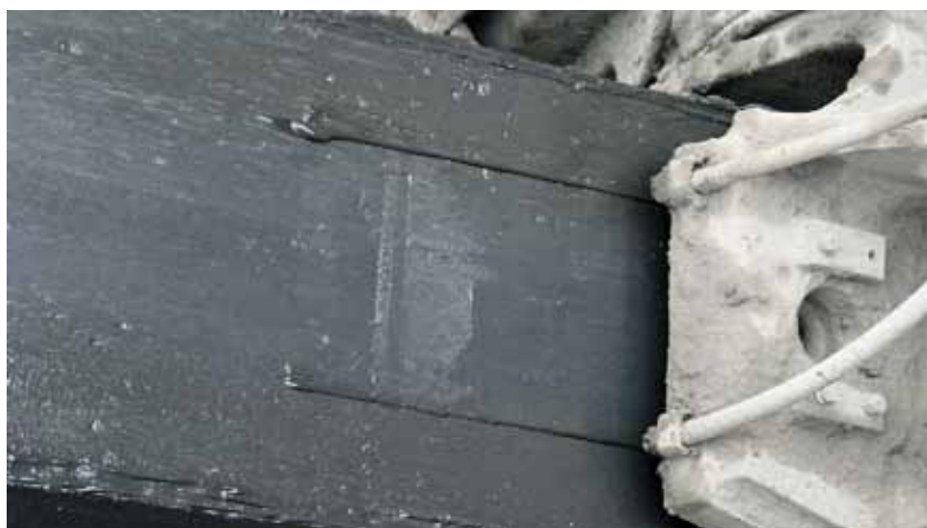
Рис. 3. Фрагмент выдавливания смазки в виде жгутиков на вертикальную поверхность рукояти ковша
