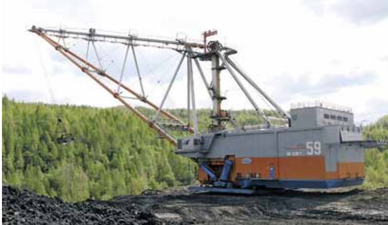
Шагающий экскаватор ЭШ-20/90С производства ПАО «Уралмашзавод»
