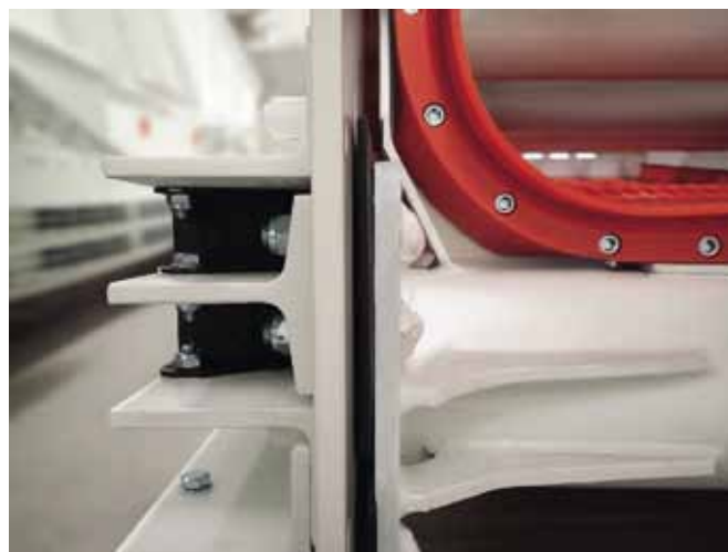
Рис. 1. Резиновые элементы, связывающие раму с подвижными балками и корпус грохота
