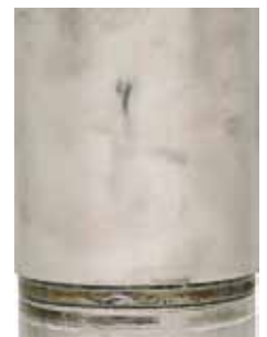
Гильза двигателя, который работал с оригинальной охлаждающей жидкостью, имеющей антикавитационные присадки.
