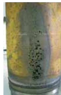
В систему охлаждения была залита универсальная охлаждающая жидкость – отчетливо видны разрушения гильзы, вызванные кавитацией.
