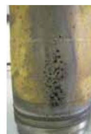
В систему охлаждения была залита универсальная охлаждающая жидкость — отчетливо видны разрушения гильзы, вызванные кавитацией
