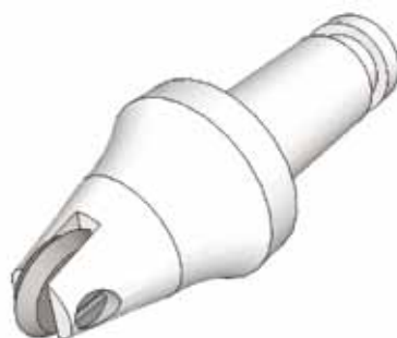
Рис. 2. Резец со сменной рабочей головкой, оснащенной режущим диском
