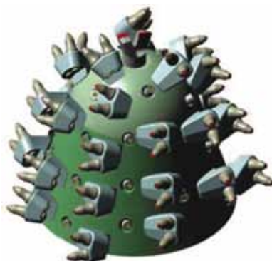
Рис. 3. Корона комбайна 1ГПКС со спаренными резцами
