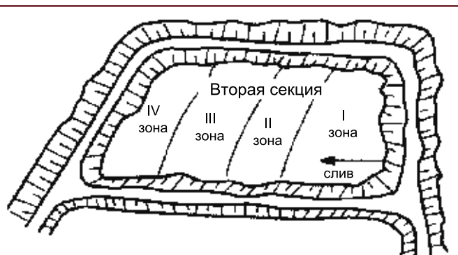
Рис. 1. Схема разбивки золоотвала по зонам в зависимости от физико-механических характеристик
