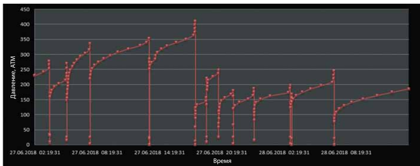
Рис. 1. Кривые изменения давления в стойке секций механизированной крепи № 88 в ограниченном временном интервале Fig. 1. Curves of pressure change in the rack sections mechanized lining No. 88 in a limited time interval
