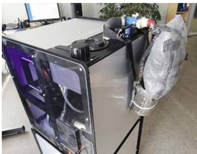
Рис. 5. Испытание ШСС-Т на имитаторе внешнего дыхания «ОКСИ-РОБОТ» при моделировании движения человека по маршруту шахты Fig. 5. Test of the ShSS-T on the Oxy-Robot external respiration simulator when simulating human movement along a mine route
