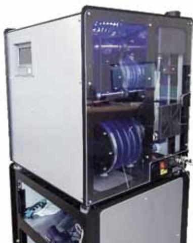
Рис. 1. Имитатор внешнего дыхания человека «ОКСИ-РОБОТ»
