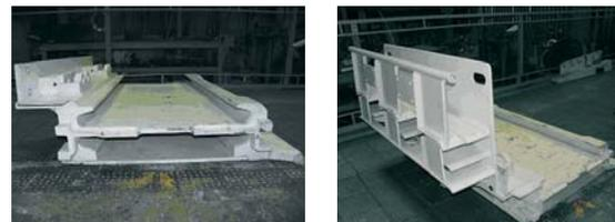
Решточный став скребкового конвейера «Юрга-950»
