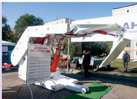
Крепи механизированные поддерживающе-оградительные предназначены для механизированного крепления призабойного пространства, поддержания и управления кровлей способом полного обрушения, передвижки забойного конвейера при ведении очистных работ на пологих и наклонных пластах в шахтах, опасных по газу и пыли. Крепи используются для совместной работы в комплексах с забойными конвейерами Анжера-30, Анжера-34, Анжера-38, Анжера-42 и очистными комбайнами ведущих производителей.
