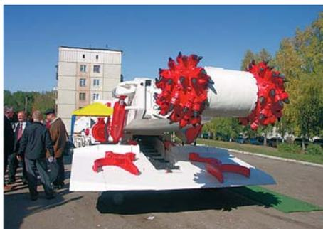
**ОАО «Анжерский машиностроительный завод»** (г. Анжеро-Судженск) имеет большой опыт в области создания нового горно-шахтного оборудования. В Кемерово на открытой экспозиции завод представил свой проходческий комбайн КПА-150, секцию механизированной крепи ряда: 2KM800K, 2KM800И, KM1000, KM1400 и буровой станок серии Б 200.
