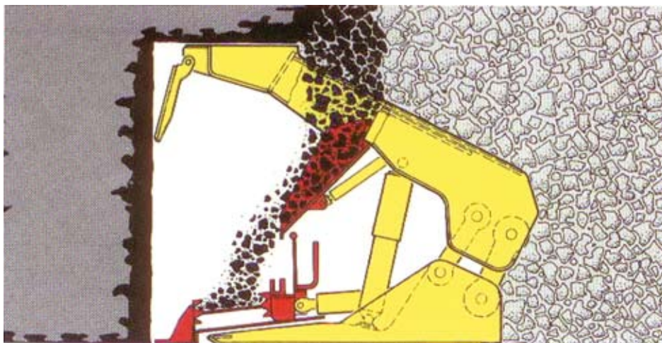
Рис. 1. Комплекс с выпуском угля в верхней части ограждения на забойный конвейер
