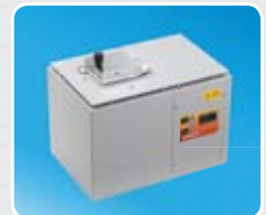
Печь для определения индекса свободного вспучивания угля и кокса (серия SNF)
