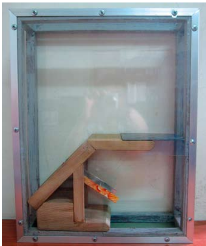
Рис. 1. Стенд изучения взаимодействия сыпучего материала с узлами механизированной крепи
