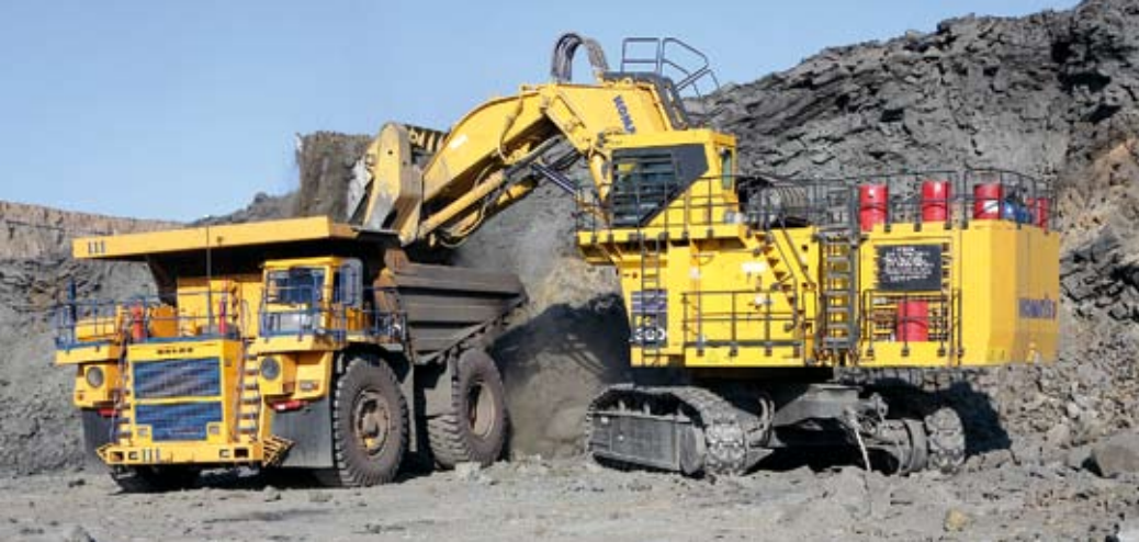
Рис. 6. Погрузка вскрышных пород экскаватором Komatsu PC-3000 в автосамосвал БелАЗ-7513
