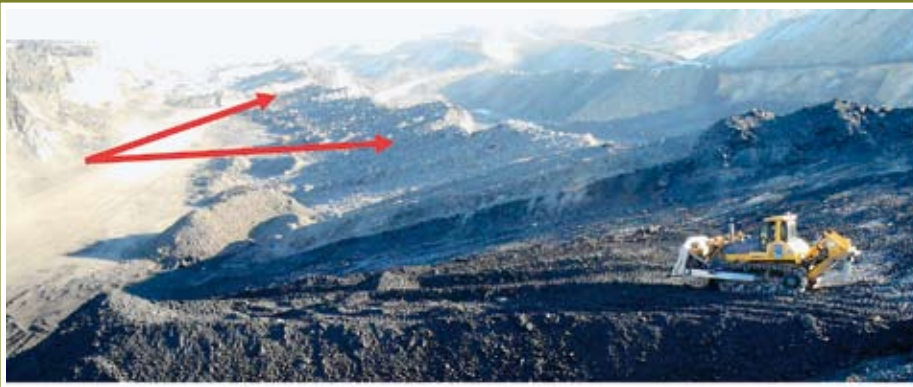
Рис. 3. Породная перемычка, остающаяся при традиционной выемке угольных пластов
