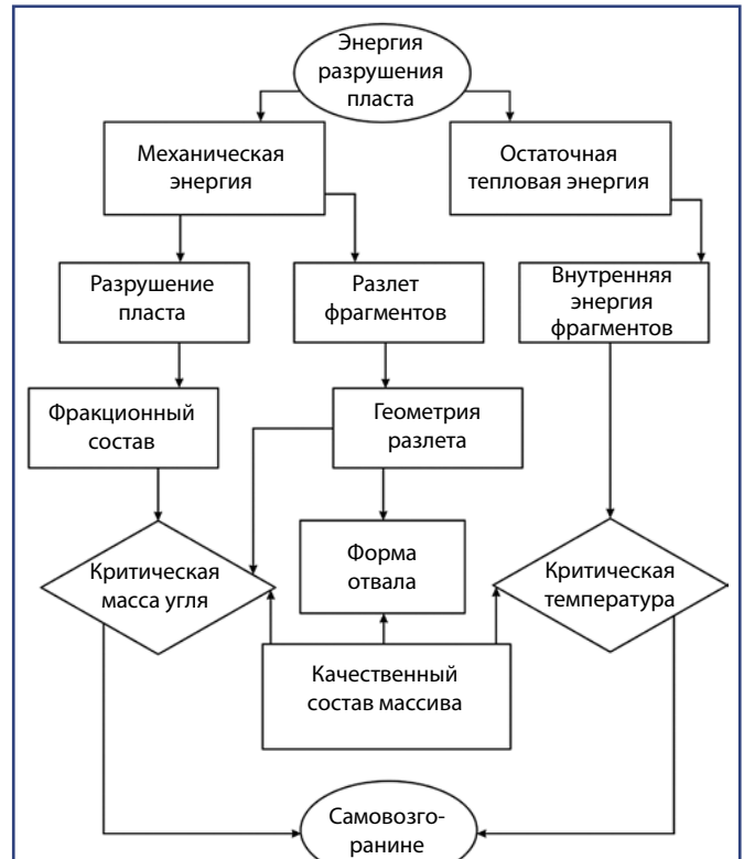
Рис. 1. Физическая модель формирования предпосылок к самовозгоранию углепородных отвалов на открытых разработках
