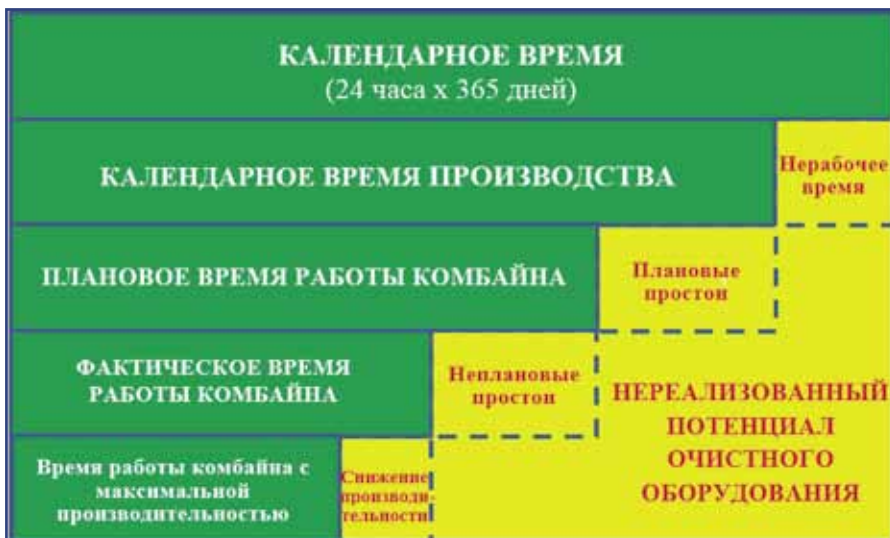
Рис. 3. Структура рабочего времени и простоев высокопроизводительного очистного оборудования
