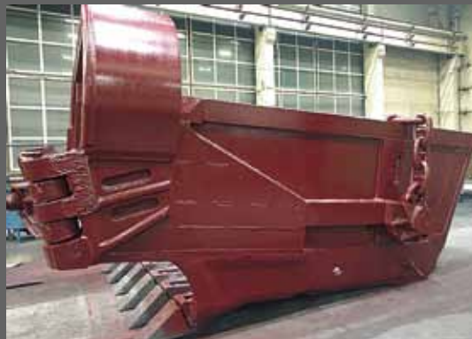
Изготовление ковшей ЭШ-20/90
