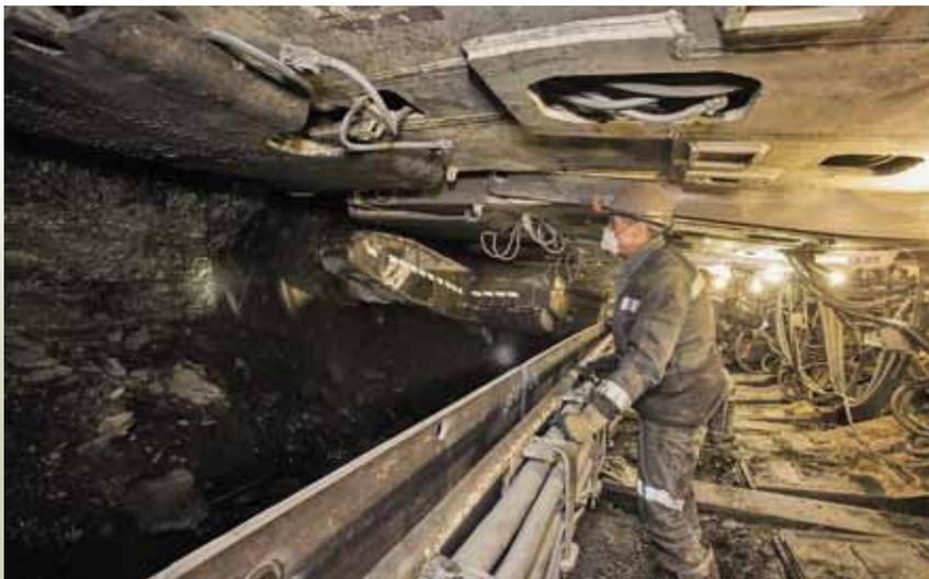
Вынимаемая мощность отрабатываемого пласта «Толмачевский» составляет 2,9 м. В лаве установлен комбайн SL-300 (Германия). Забой также оборудован 151-й секцией крепи Tagor и Glinik (Польша), лавным конвейером SH PF-4/1032 (Германия). Ожидаемая среднемесячная производительность забоя составляет не менее 300 тыс. т угля.
