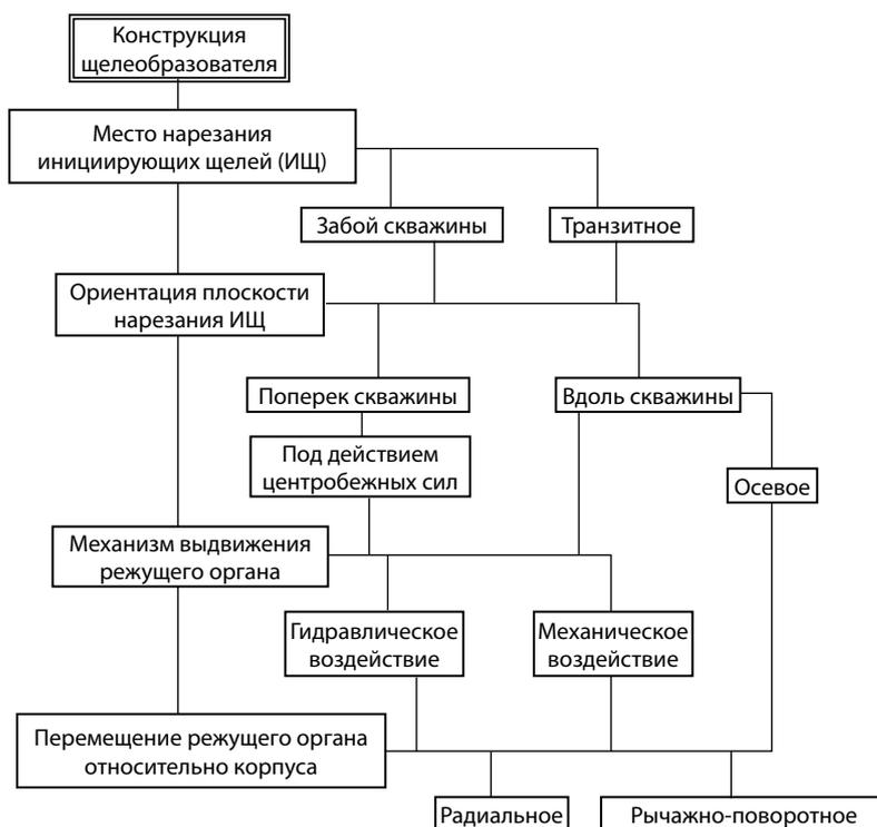
Рис. 1. Классификация устройств для нарезания инициирующих щелей
