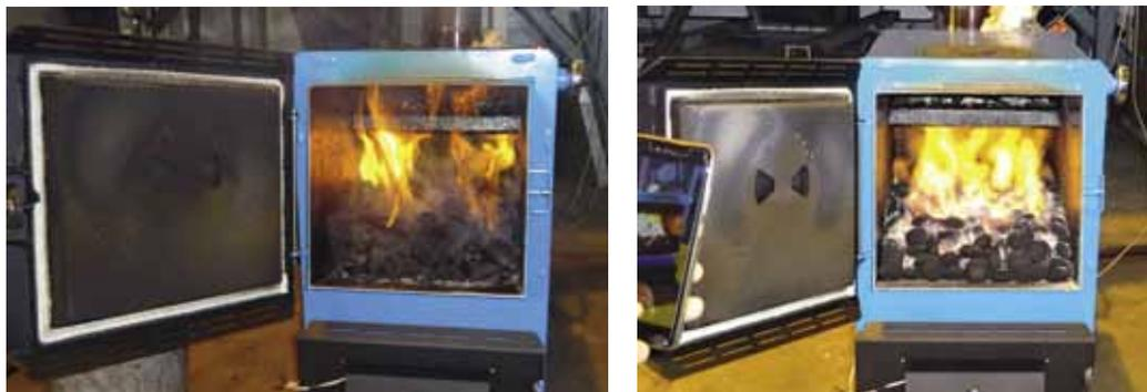
Рис. 4. Экспериментальный стенд на базе бытового котла для тестирования топлива: слева – сжигание угля, справа – сжигание бездымных брикетов
