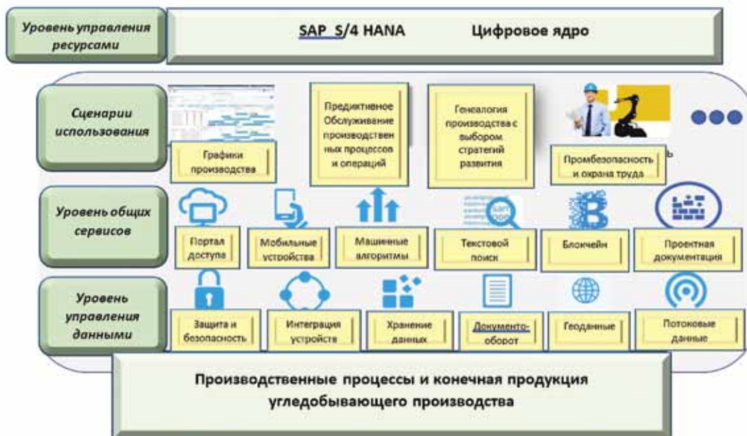
Рис.1. Состав цифровых технологий концепции создания цифрового угледобывающего предприятия (SAP Connected Manufacturing)
