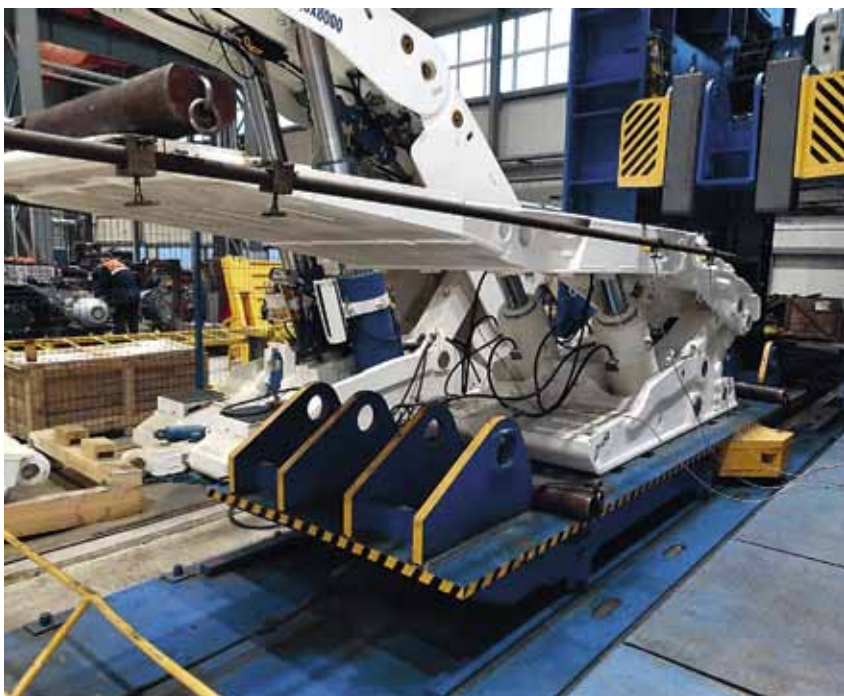
Статические испытания модернизированной секции МКЮ-2У-09/23
