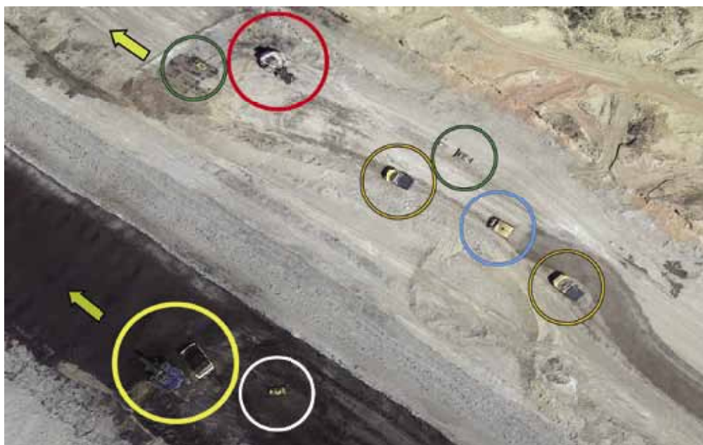
Рис. 1. Фрагмент космоснимка вскрышных и добычных работ в угольном карьере на территории штата Монтана (США)
