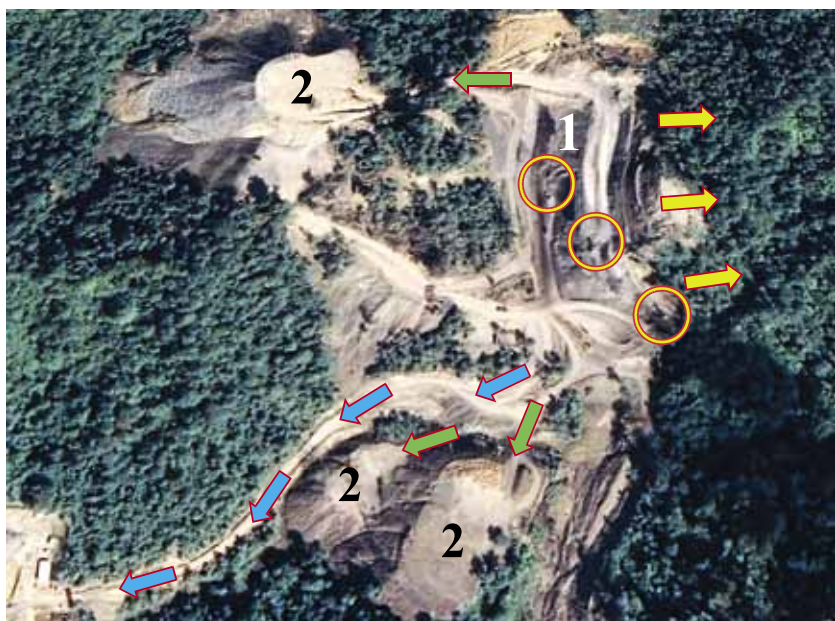
Рис. 1. Фрагмент открытых горных работ на месторождении угля в районе горного массива Ракхайн (на снимке из космоса): 1 – карьер; 2 – внешние породные отвалы
