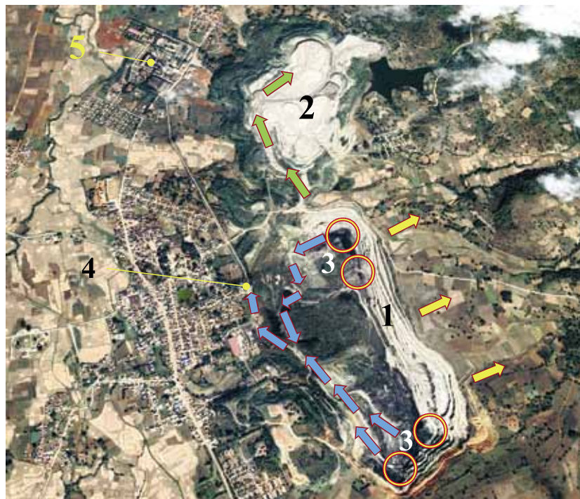
Рис. 2. Фрагмент космоснимка с расположением угольного карьера по добыче угля, внешнего породного отвала и тепловой электростанции: 1 – карьер; 2 – внешний породный отвал; 3 – сектора карьера, в которых производят добычу угля; 4 – дробильная установка для угля с выпуском на конвейер; 5 – тепловая электростанция
