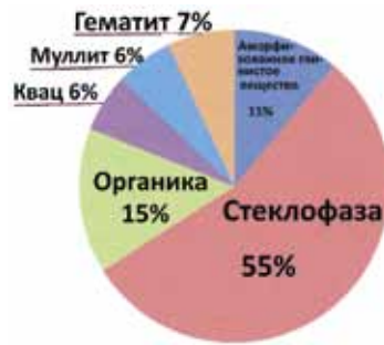
Рис. 2. Минералогические составы сырьевых компонентов и обожженный образец:
