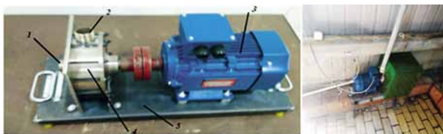
Рис. 2. Устройство для активации раствора: 1 – входной патрубок; 2 – выходной патрубок; 3 – электродвигатель; 4 – генераторный блок; 5 – платформа
