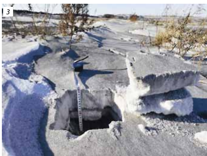
Рис. 1. Замеры глубины снежного покрова в бороздах-щелях на полигоне рекультивации и промышленном опыте: 1 – свеженарезанные борозды-щели на автомобильном отвале; 2, 3 – сформированные борозды-щели на полигоне рекультивации
