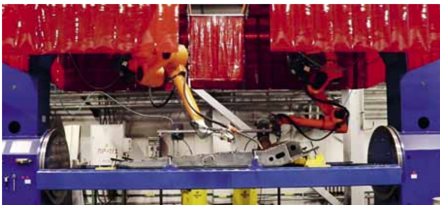
Рис. 2. Роботизированный комплекс CLOSS для сварки металлоконструкций
