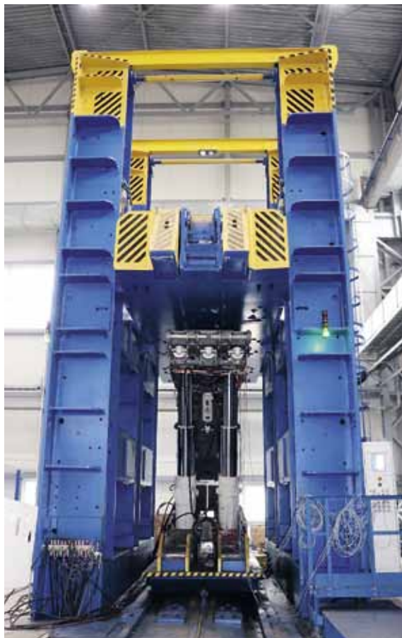
Рис. 5. Стендовые испытания секции крепи КН-16/37
