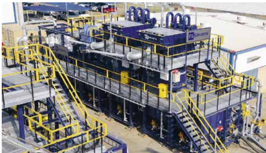
Рис. 9. Общий вид установки REFLUX™ классификаторов (обогащение углей)
