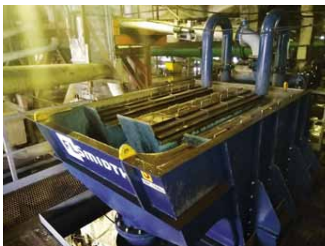
Рис. 10. Установка REFLUX™ классификатора на углеобогащательной фабрике
