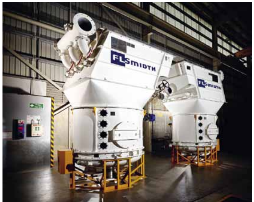
Рис. 6. Заводская тестовая сборка RC™2000 REFLUX™ перед поставкой
