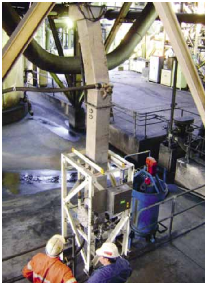
Рис. 7. Опытно-промышленный классификатор REFLUX™ RC™300
