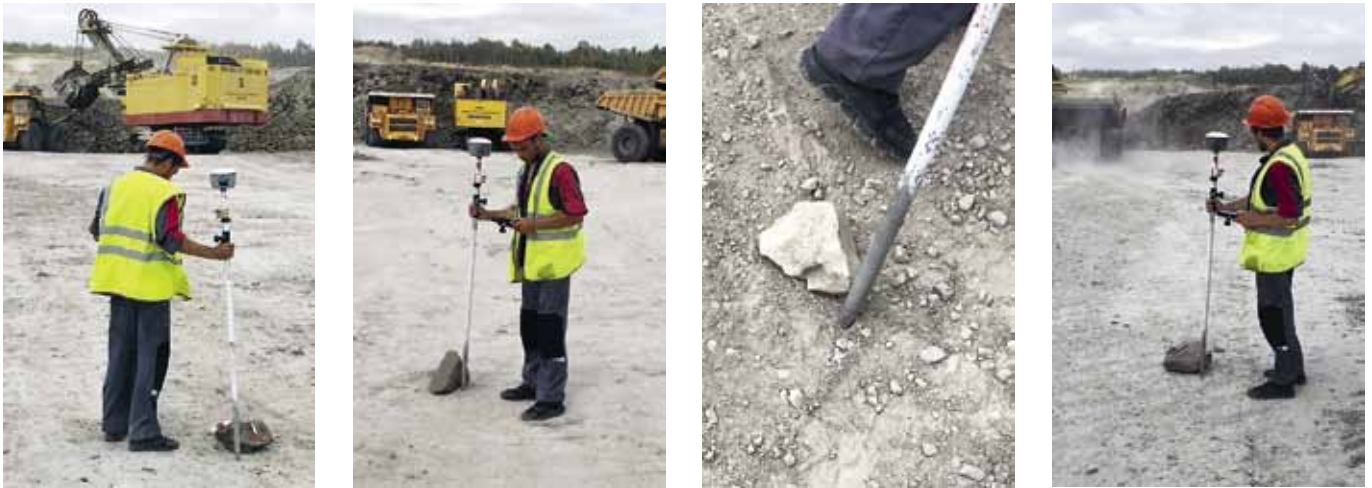
Рис. 1. Измерения дальности разлета отдельных кусков породы на СУР Fig. 1. Measurements of the fly ranges of individual rock pieces at the Solntsevsky Coal Mine
