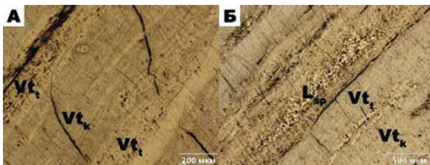
Рис. 2. Микрофотография фрагмента аншлиф-брикета. Отраженный свет, анализатор выключен, Vt_t – телинит, Vt_k – коллинит, L_{sp} – споринит
