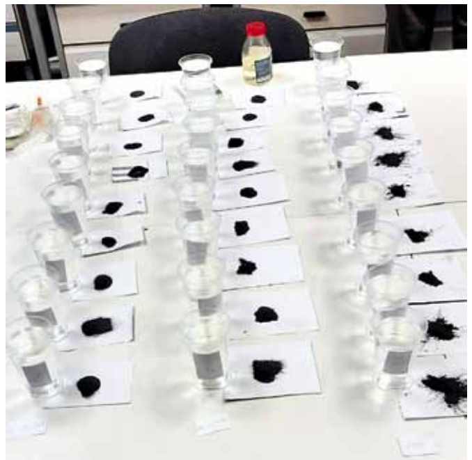
Рис. 2. Растворы смачивателя и пробы пыли Fig. 2. Wetting agent solutions and dust samples
