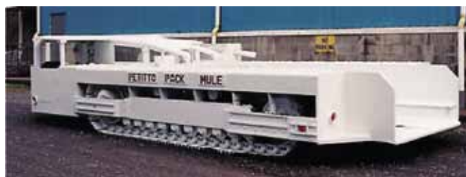
Рис. 5. Машина Petitto Mule модели 4070, предназначенная для транспортировки секций крепи по горным выработкам
