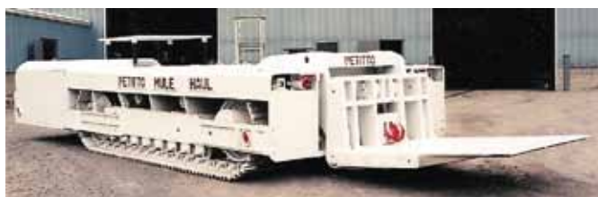
Рис. 3. Машина Petitto Mule модели 3050 для монтажа секций крепи
