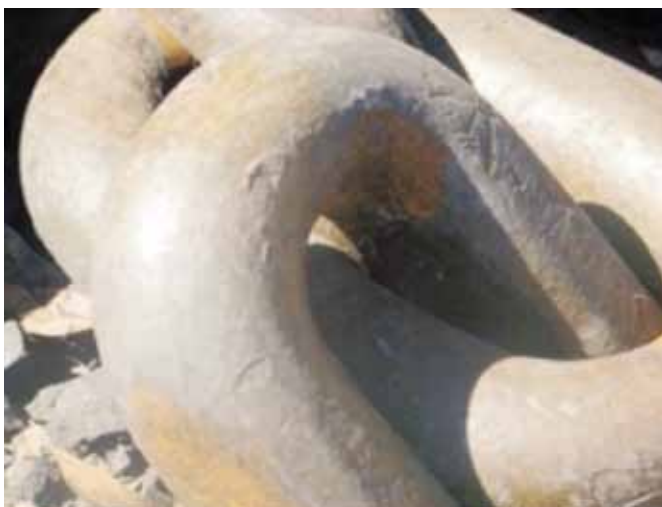
Рис. 7. Состояние цепи в результате эксперимента на шахте Austar (Австралия):
