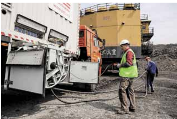
Перегонный комплекс перегоняет в забой экскаватор WK-35
