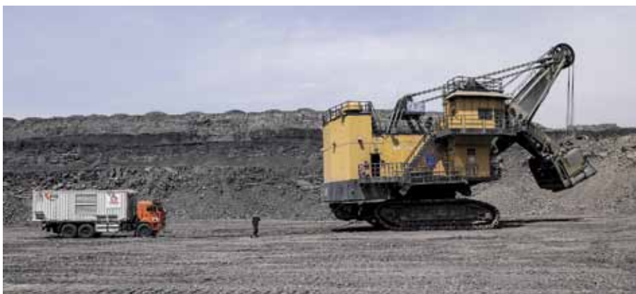
Подключение перегонного комплекса к экскаватору занимает 1,5 часа
