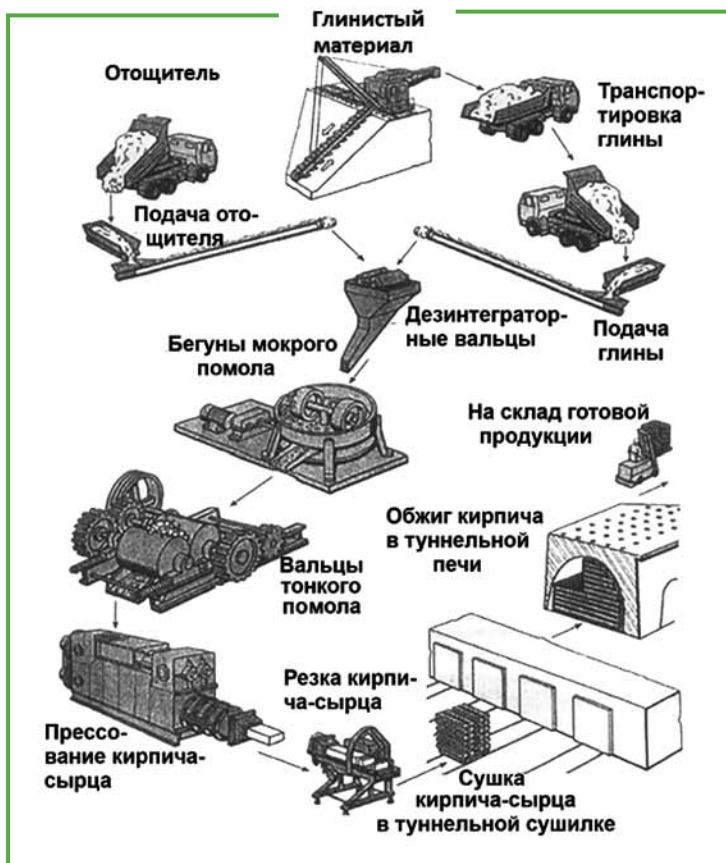
Рис. 3. Технология получения керамического кирпича
