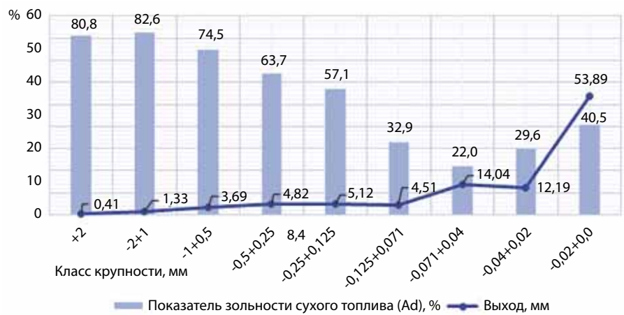
Рис.1. Гранулометрическая характеристика исходного сырья с показателями зольности сухого топлива по классам крупности
