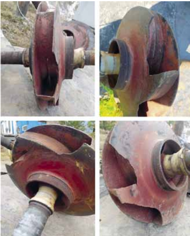
Рис. 1. Разрушенные колеса насосов ГВУ
