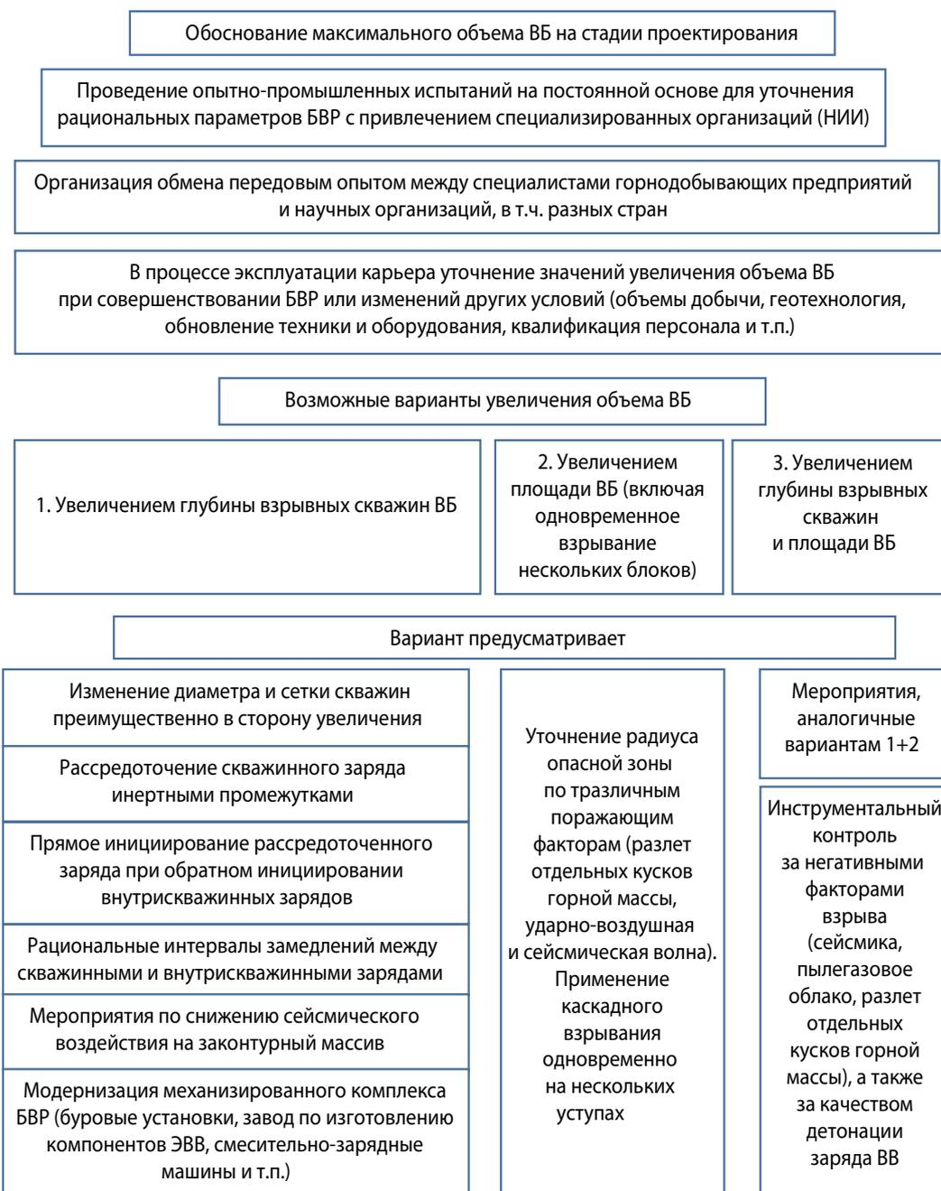
Рис. 2. Схема методики увеличения объема взрывного блока
