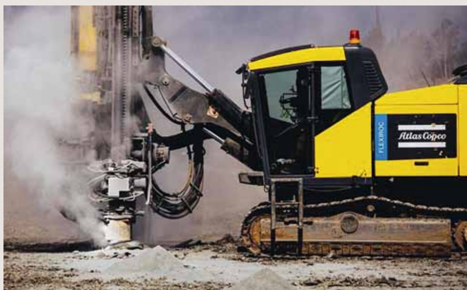
Рис. 1. RC-бурение возможно: в обводненном массиве; на рудных складах и/или под покровной толщей четвертичных отложений/наносов; в условиях аллювиальных отложений
