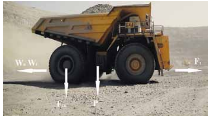
Рис. 1. Движение автосамосвала с грузом: F_T – сила тяги, P – вес автосамосвала, W_i, W_o – сопротивление движению
