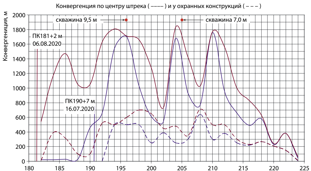
Конвергенция пород кровли и почвы конвейерного штрека № 501 за лавой: по центру выработки (сплошная кривая) и у охранных конструкций (пунктирная кривая)
