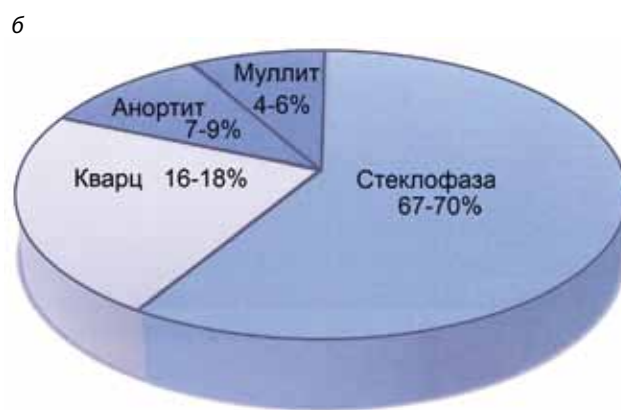
Рис. 2. Минералогический состав отходов: а – межсланцевая глина; б – зола легкой фракции
