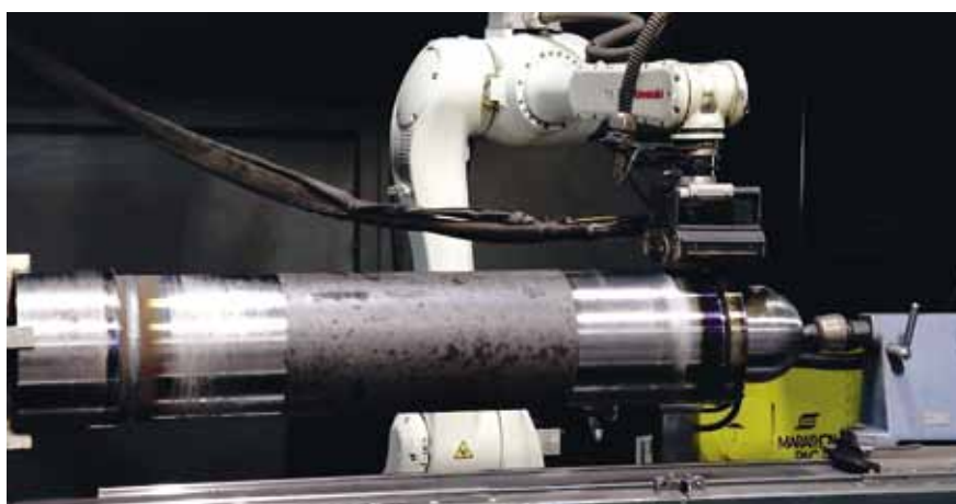
Рис. 3. Роботизированный комплекс Kawasaki для сварки цилиндров с автоматическим подогревом заготовки токами высокой частоты
