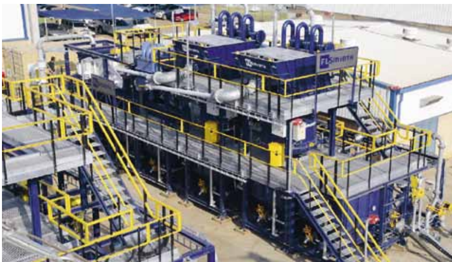
Рис. 9. Общий вид установки REFLUX™ классификаторов (обогащение углей)
