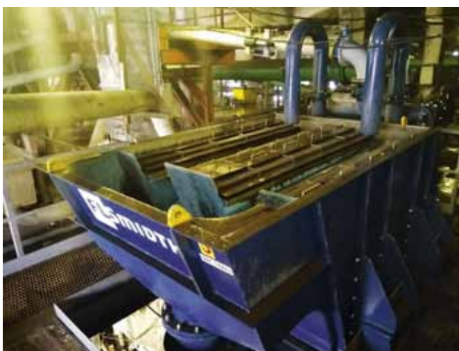
Рис. 10. Установка REFLUX™ классификатора на углеобогащательной фабрике
