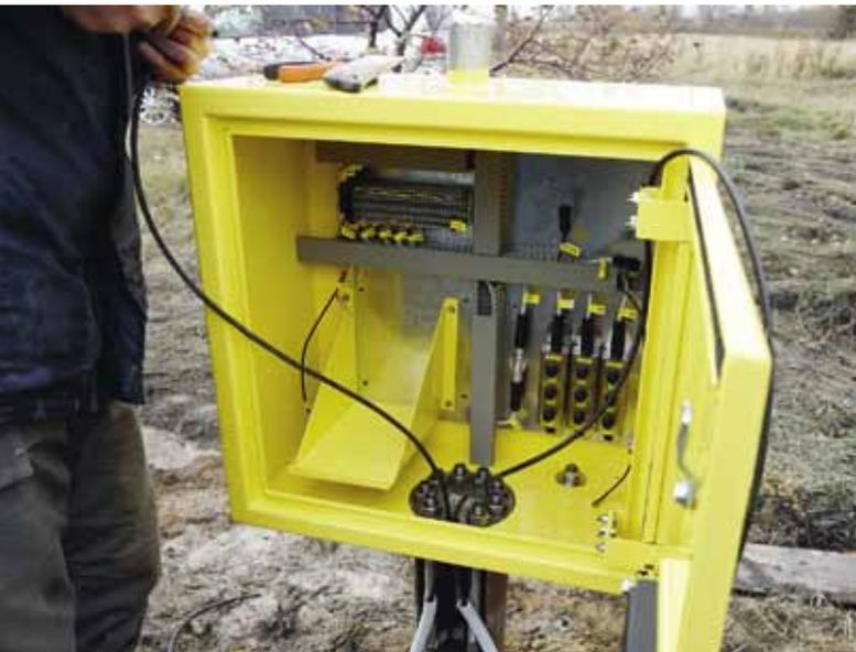
*Система контроля устойчивости бортов разреза предупредит о глубинных смещениях в массиве горных пород задолго до появления признаков деформаций на поверхности борта*
