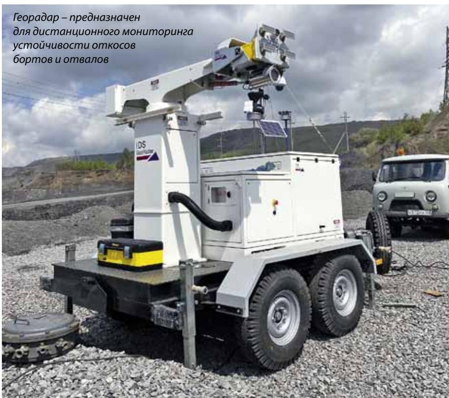
Георадар – предназначен для дистанционного мониторинга устойчивости откосов бортов и отвалов
