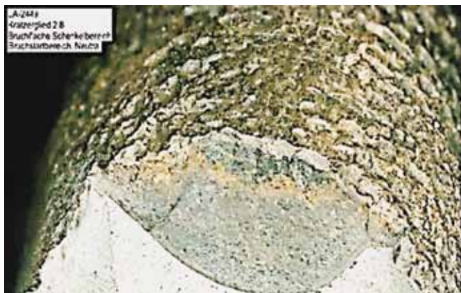
Рис. 3. Поверхностная коррозия «черной» (незащищенной) цепи и ее последствия (очаги поверхностной коррозии с последующим развитием трещины)
