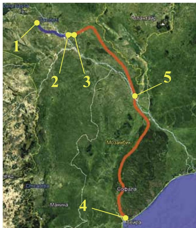
Фрагмент космоснимка [10] с расположением объектов открытой угледобычи и нанесением схемы логистики угольных потоков на территории Республики Мозамбик: 1 – карьерные поля действующих угольных разрезов вблизи сельского поселения Cauirisa; 2 – карьерные поля вблизи городов Tete и Moatize; 3 – обогатительная фабрика; 4 – морской угольный терминал; 5 – железнодорожный переход через р. Замбези
