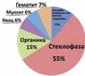
Рис. 2. Минералогические составы сырьевых компонентов и обожженный образец:
