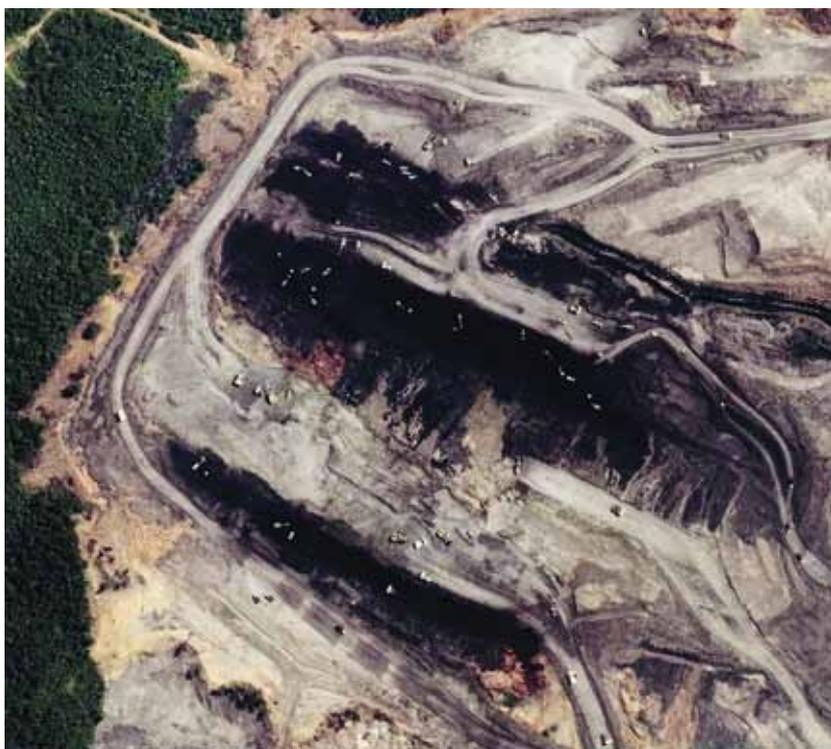
Фрагмент космоснимка открытых горных работ на угленасыщенном участке месторождения с тремя мощными пластами крутонаклонного залегания
