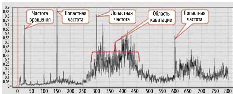
Рис. 4. Спектр вибрации насосного агрегата № 1 при его обследовании 27 июля 2021 г.
