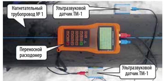
Рис. 3. Измерение подачи насоса № 1 переносным ультразвуковым расходомером STREAMLUX SLS-720P
