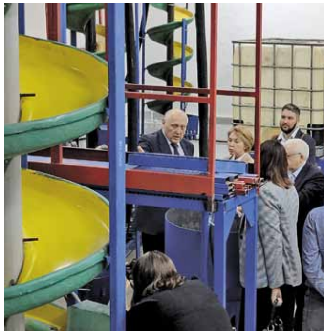
Экспериментальное оборудование для переработки хвостов угольных обогатительных фабрик Pilot equipment for processing tailings from washing plants
