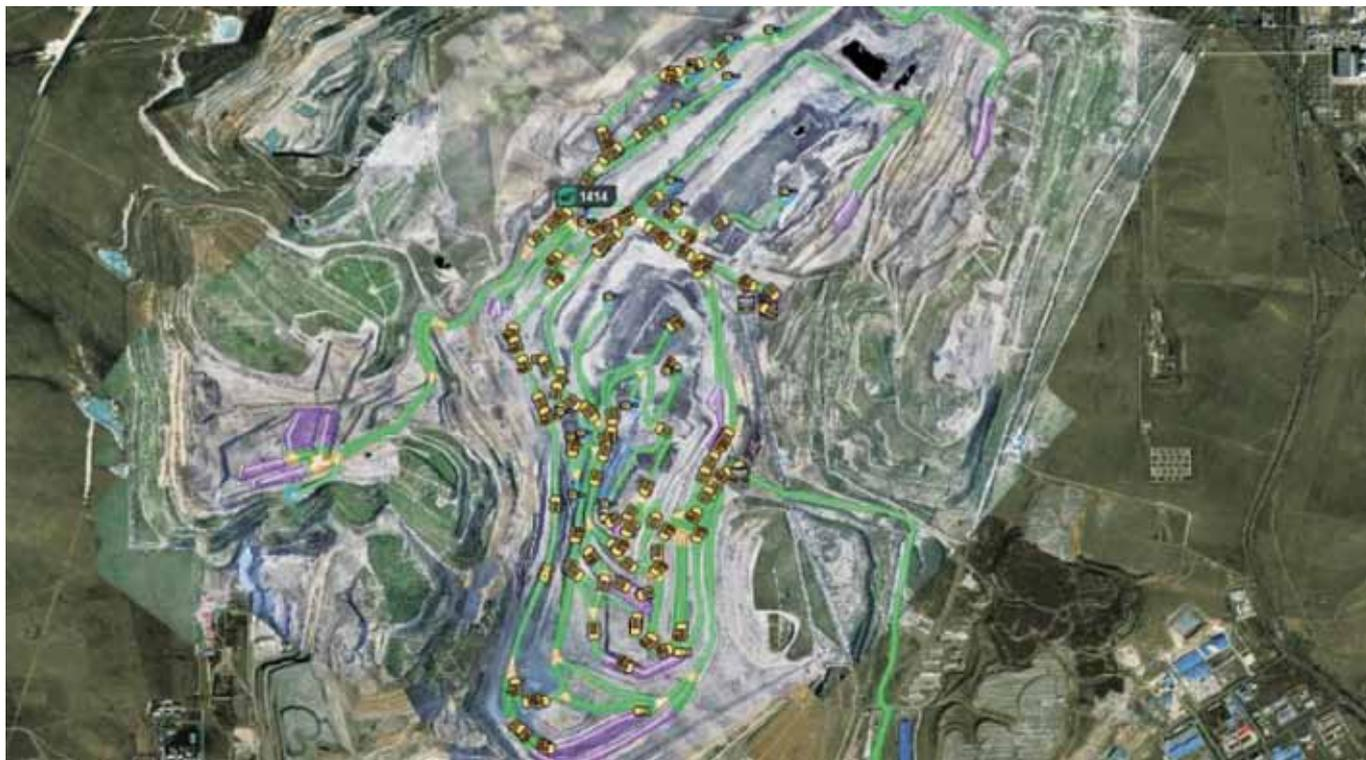
*Рис. 2. Схема заторов на перекрестках технологических трасс*
