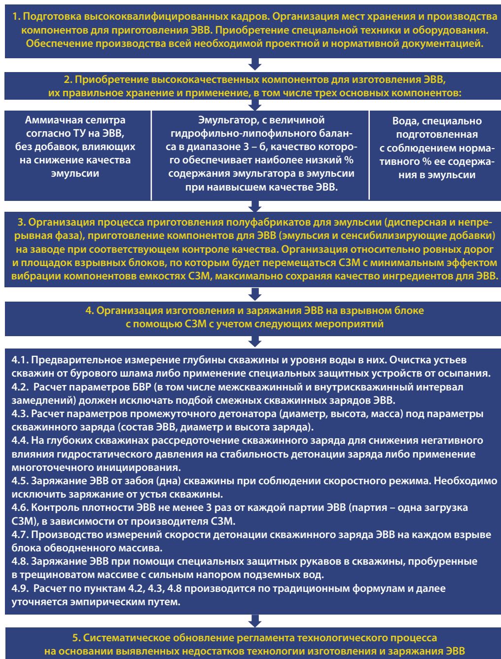
Рис. 5. Методика эффективности изготовления и применения наливных ЭВВ при взрывном разрушении обводненных массивов горных пород
