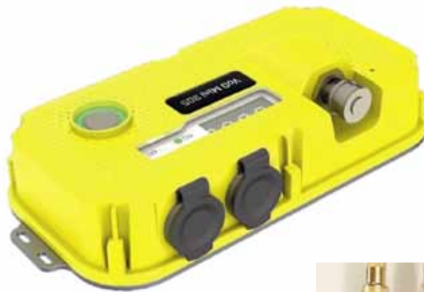
Рис. 4. Измерительный прибор VoD-305 (Австралия) – а; измеритель микросекундных интервалов времени ИВИ-4 (КТБ «Интервал», г. Новосибирск) – б
