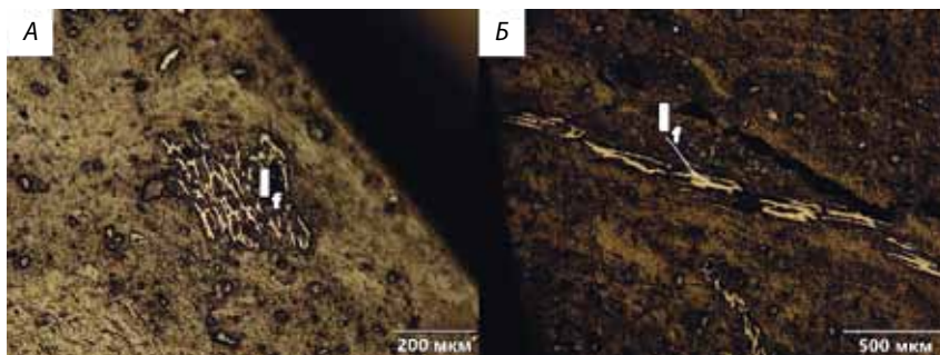
Рис. 3. Микрофотографии фрагмента аншлиф-брикета. Отраженный свет, анализатор выключен, I_p – фюзинит Fig. 3. Microphotographs of a polished briquette fragment. Reflected light, PPL, L_p – fusinite
