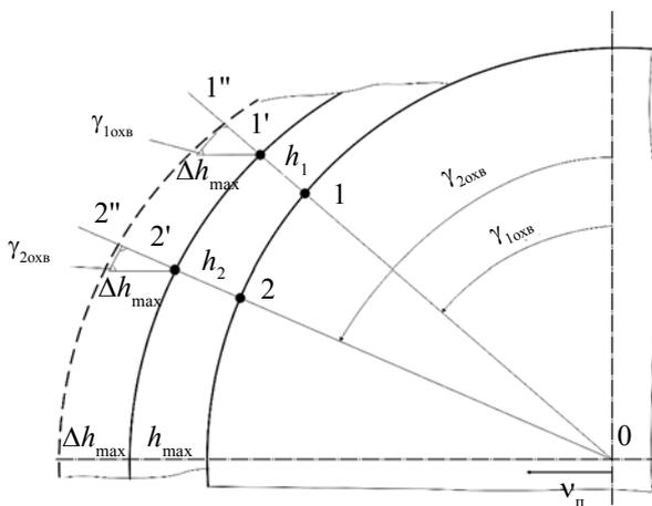
Схема определения коэффициента вариации толщины стружки на резах исполнительного органа:
